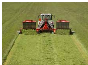
Укладка в расстил по всей ширине
