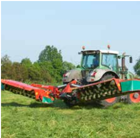
Большой просвет во время разворотов на поворотной полосе поля.
