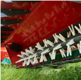
Эффективная плющилка, оснащенная нейлоновыми пальцами.
